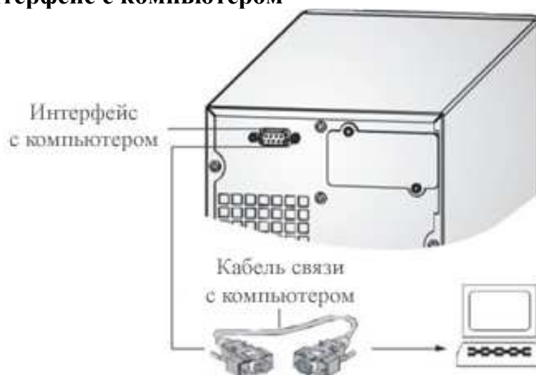
Рисунок 3.4 - Интерфейс с компьютером
