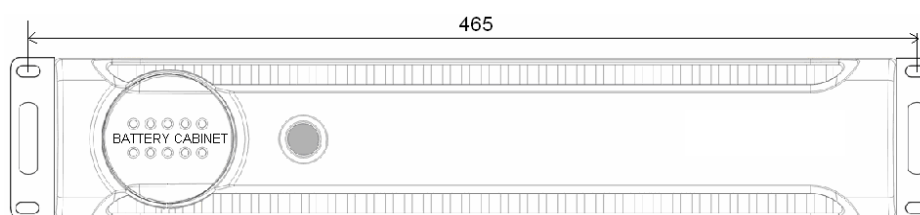
ИБП для установки в телекоммуникационную стойку
